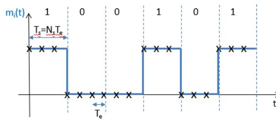
FIGURE 3 – Exemple de signal NRZ unipolaire
