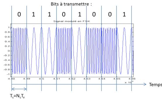
FIGURE 2 – Signal modulé en fréquence - Modulation 2-FSK
