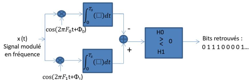
FIGURE 5 – Démodulation FSK. Synchronisation supposée idéale.
