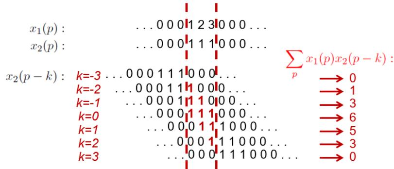
FIGURE 3.7 – Produit de convolution linéaire entre les signaux  $x_1 = [1\ 2\ 3]$  et  $x_2 = [1\ 1\ 1]$
